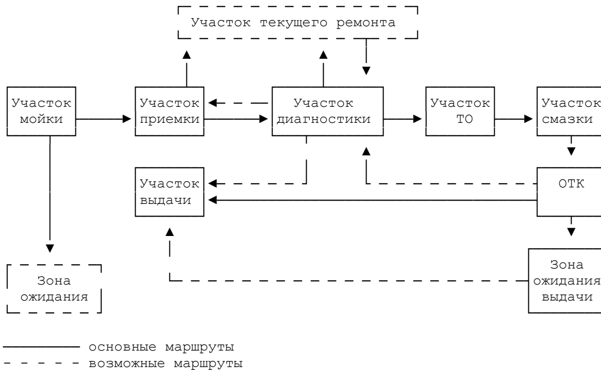
Схема производственного процесса полнообъемного ТО на СТОА
